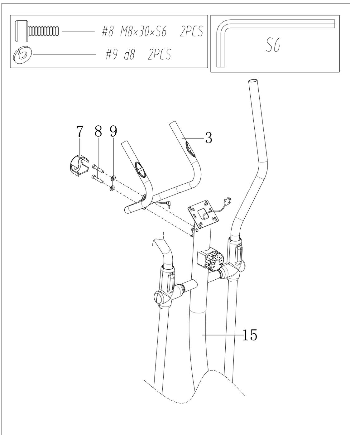
1. Прикріпіть руль (3) до опорної трубі (15) за допомогою гвинта (8), пружинної шайби (9) і кришки (7).
