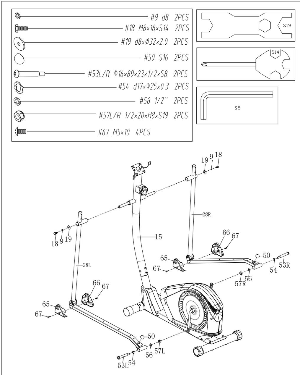
1. Посуньте хитний стержень (28L / R) на опорну трубу (15) з шестигранним болтом (18), пружинною шайбою (9) і шайбою (19).
