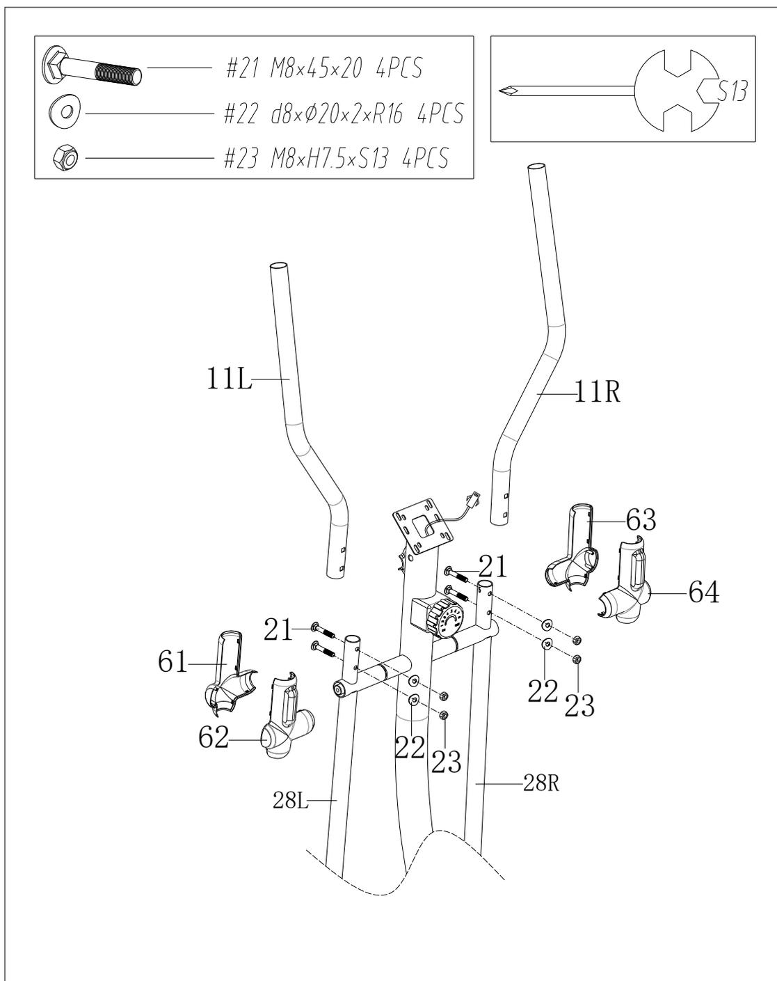
1. Прикріпіть руль (11L/R) до поворотного стержня (28L/R) з допомогою кареточного болта (21), дугового шайби (22) і гайки з нейлонової вставкою (23).
