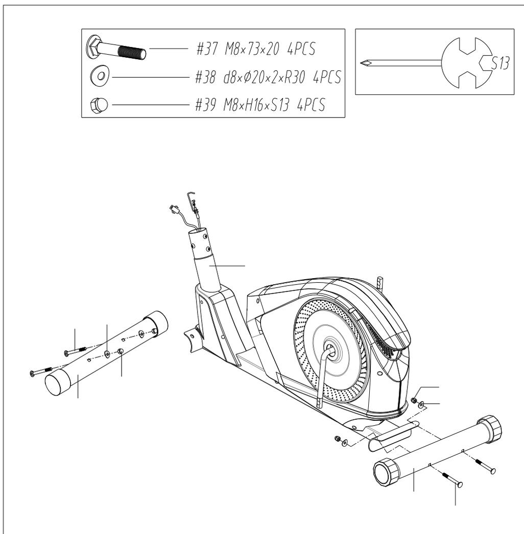
1. Прикріпіть передній стабілізатор (33) і задній стабілізатор (34) до головної рами (58) за допомогою каретного болта (37), дугової шайби (38) і куполоподібної гайки (39).
